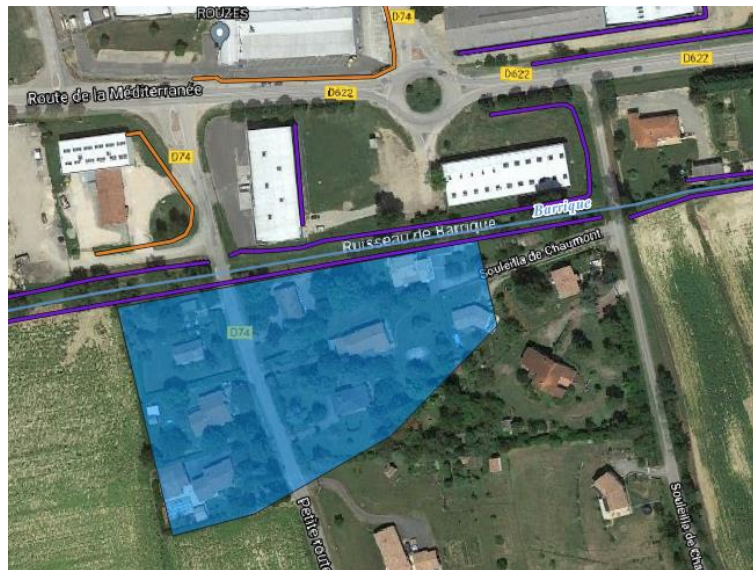
Figure 22 : Zone protégée pour l'événement décennale par le merlon 10 en rive gauche du ruisseau de Barrique
