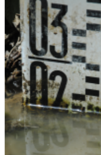
Avec 22 cm à la station de mesure de Labarthe le débit est inférieur à 30 L/s
