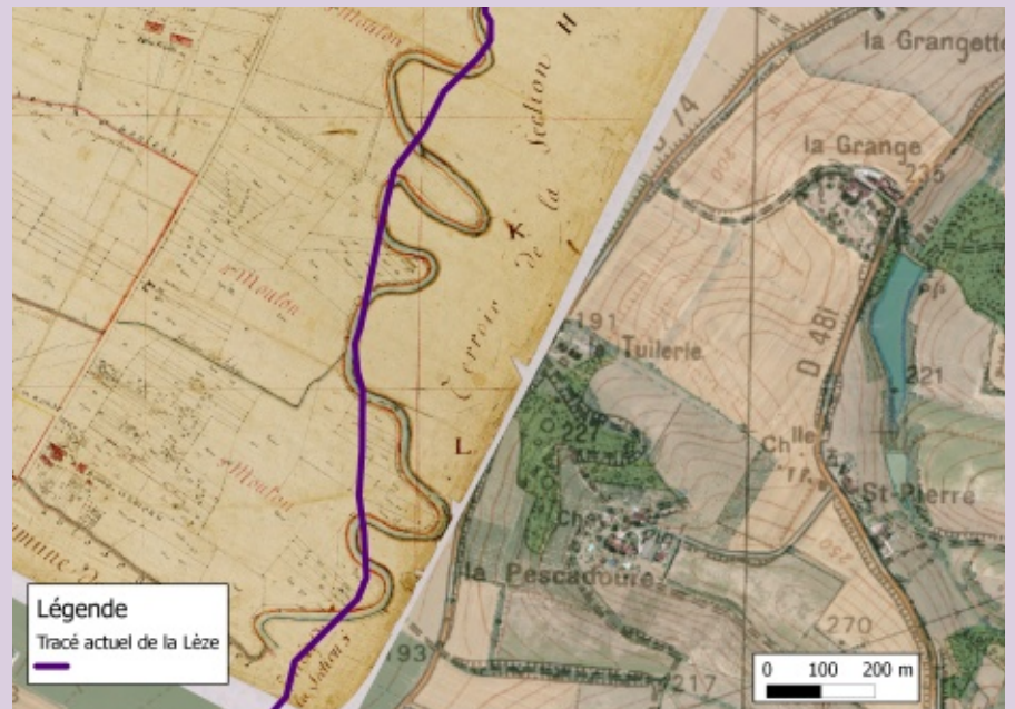
Travaux de redressement de méandres vers 1864, Beaumont sur Lèze
